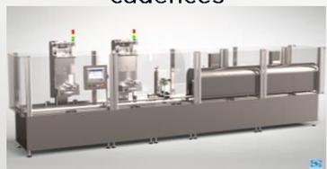
Combireel®: le magasin multi-bobines à raccordement automatique
